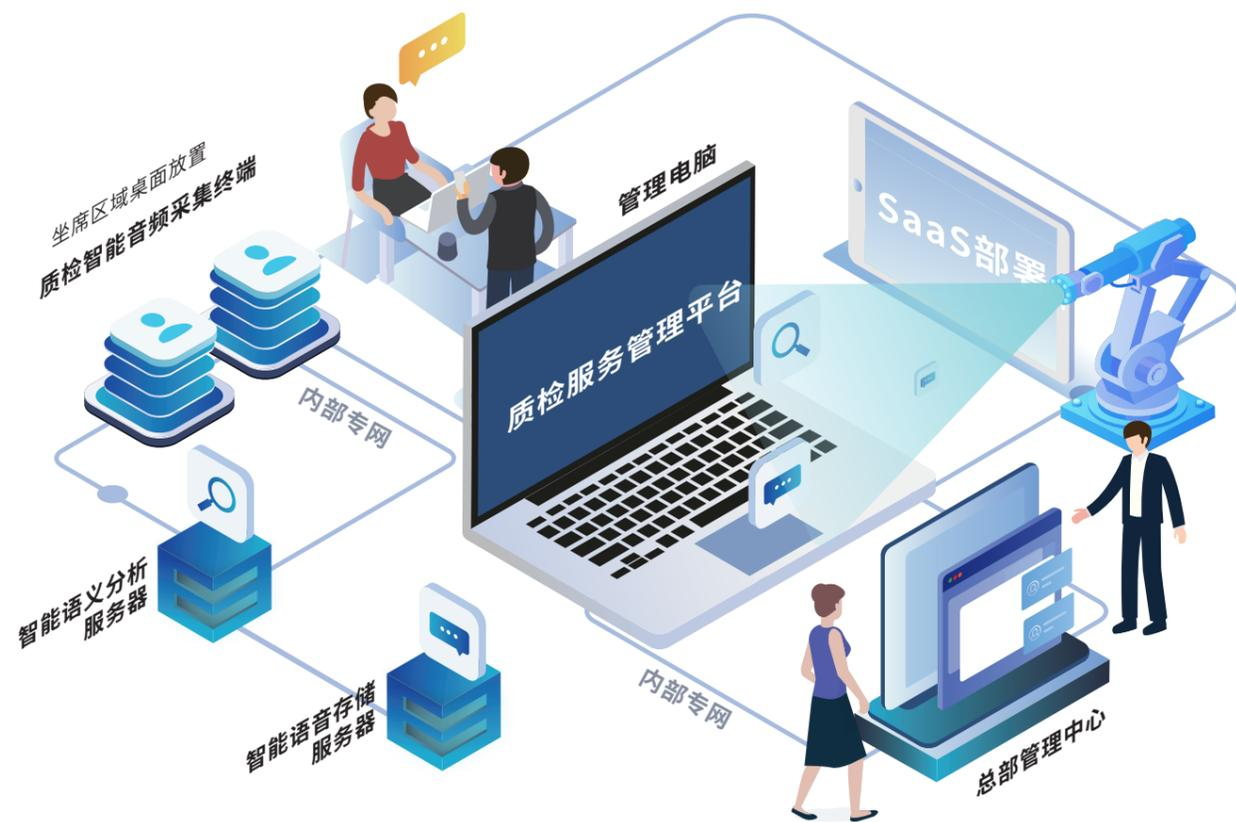
营业场所智能语音质检系统解决方案整体采用分布式网络架构设计，基于B/S架构访问模式。系统主要是由质检智能音频采集终端、智能语音存储服务器、智能语义分析服务器、质检服务管理平台、管理电脑等设备组成。通过充分考虑营业场所具体工作业务场景，采用不同的产品形态进行优化部署针对固定工作区采用桌面安装的质检智能音频采集终端进行部署管理。系统主要是通过部署具备人声还原、角色分离、噪声抑制、双指向等功能的专业质检智能音频采集终端，解决复杂环境下顾客和工作人员声音采集，并通过角色分离技术推送工作人员服务用语到质检管理平台端进行工作人员服务规范用语监督与溯源。
